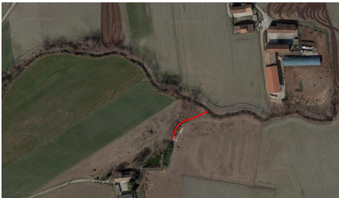
I lavori consisteranno nello scavo del canale con rimozione della tubazione in cls, la creazione di una sezione trapezia con base minore pari a 2 metri (larghezza del fondo) ed il deposito del materiale scavato su entrambi i lati. Data la natura dei terreni e la presenza di acqua, le sponde saranno consolidate lungo tutto il loro sviluppo mediante una palificata in legname, tipologia spesso impiegata per questo tipo di opere.
