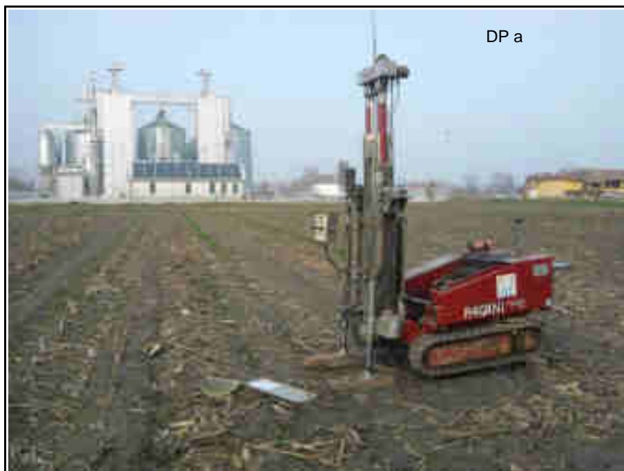
Foto 3 – Fase di esecuzione della prova penetrometrica DPSH3 MASW 1
