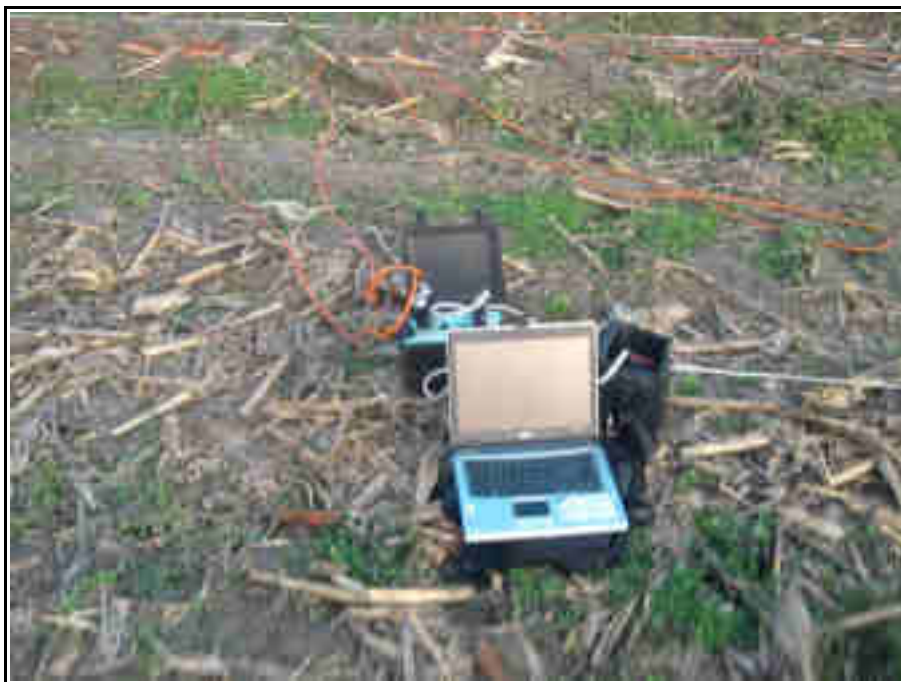
Foto 5 – Particolare dell'attrezzatura utilizzata per l'indagine sismica (MASW)
