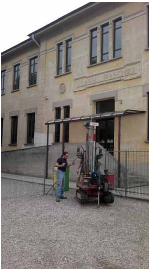
Figura 2: collocazione prova penetrometrica dinamica
