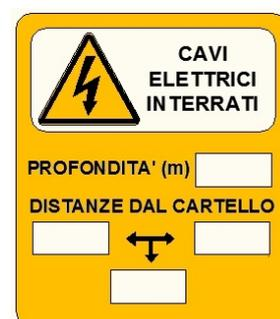
Spesso capita che anche dopo i rilevamenti elettronici, non sia possibile individuare l'esatta posizione delle stesse linee. Se si presume di essere a ridosso delle canalizzazioni è quindi fondamentale, ai fini della sicurezza, che il lavoro di scavo sia eseguito con cautela e, ove fosse necessario, con interventi manuali.
